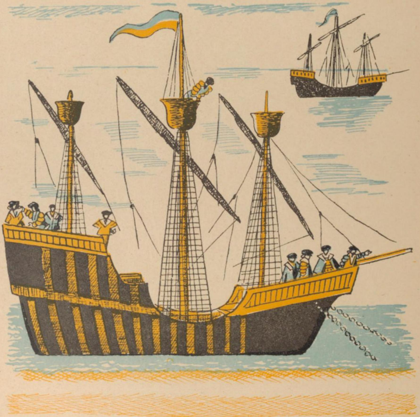
Car les mâts de ces navires étaient surmontés de hunes ou « gabies », sorte de plates-formes d'où on pouvait explorer l'horizon ou, pendant les combats, arroser l'adversaire de flèches ou de liquides bouillants.
